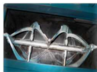
Design brevettato delle lame di triturazione "a doppia elica"
